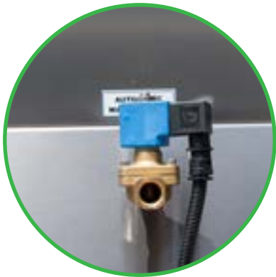
ELEKTROMAGNETVENTIL FÜR DIE BEFÜLLUNG
