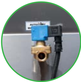
ÉLECTROVANNE DE REMPLISSAGE
